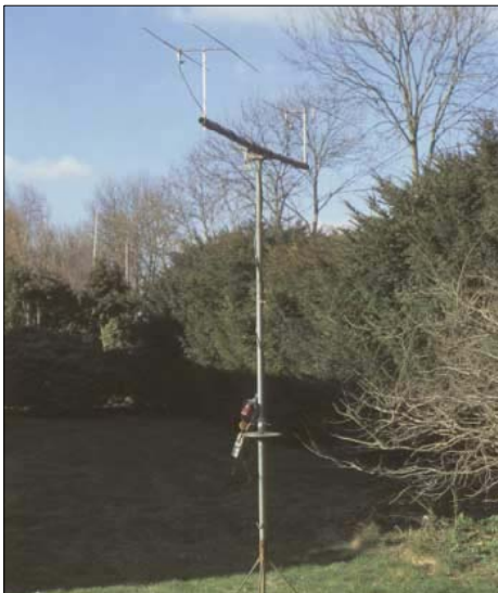
Bild 1: Ansicht der beschriebenen Peileinrichtung mit zweimal HB9CV
