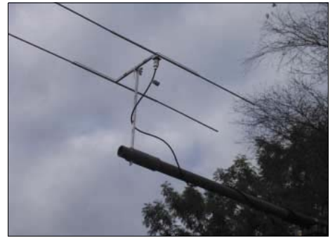
Bild 2: Montage der zerlegbaren HB9CV am Antennenträger
