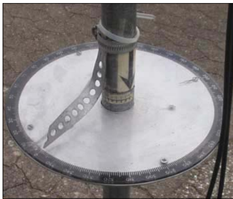
Bild 5: Gradanzeige in „Low-Tech-Ausführung“ Fotos: DF7BL
