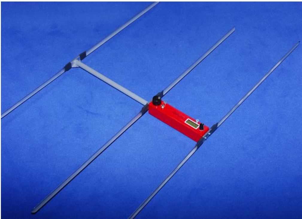
Einsatzbereiter Peilempfänger mit angebauter 3-Element-Yagi
