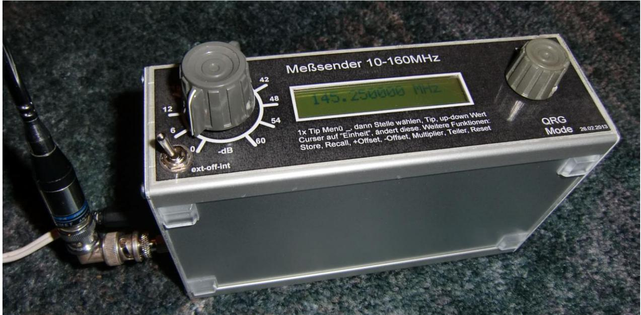
Funkamateurl hat aber auch ein kleines Bedienteil für den Synthesizer im Angebot. Damit läßt sich wie im Folgenden beschrieben, ein kleiner Meßsender aufbauen. Offiziell wird ein Frequenzbereich von 10 bis 160 MHz genannt. Bei mir funktionierte der Synthesizer auch noch bei 3,5 MHz (80m-Band).
