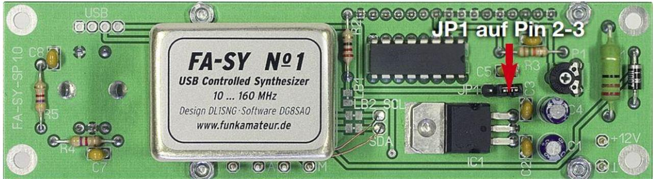
Der im Synthesizer FA-SY vorhandene Mikroprozessor wird durch eine mitgelieferte neue Version ausgetauscht, die das Mikroprogramm sowohl für PC- als auch für die Direktsteuerung enthält. Das Display wird über einen I<sup>2</sup>C Portextender (PCF8574A) angesteuert, den ich bereits in meinen Empfängern einsetze.
